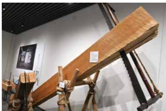
竹中大工道具館で常設展示している大鋸を用いた挽割製材の様子(兵庫県神戸市)
