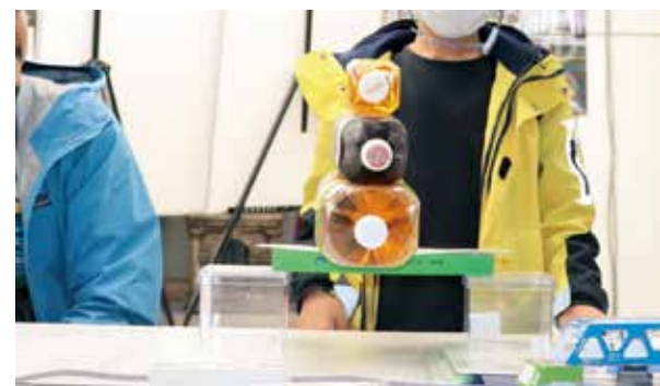
「東京 橋と土木展」で行ったペットボトル最大3.5kgを載せての耐荷試験(写真提供:一般社団法人日本橋梁建設協会)
