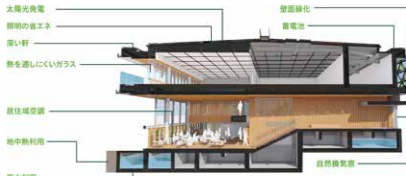
エコルとごし断面図。さまざまな省エネ・創エネで、2022年度年間エネルギー消費量97%削減を達成した(提供:品川区立環境学習交流施設 エコルとごし)
