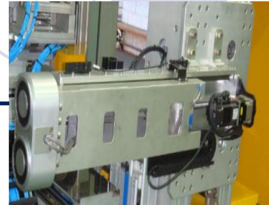
ロボットの梁への保持装置
