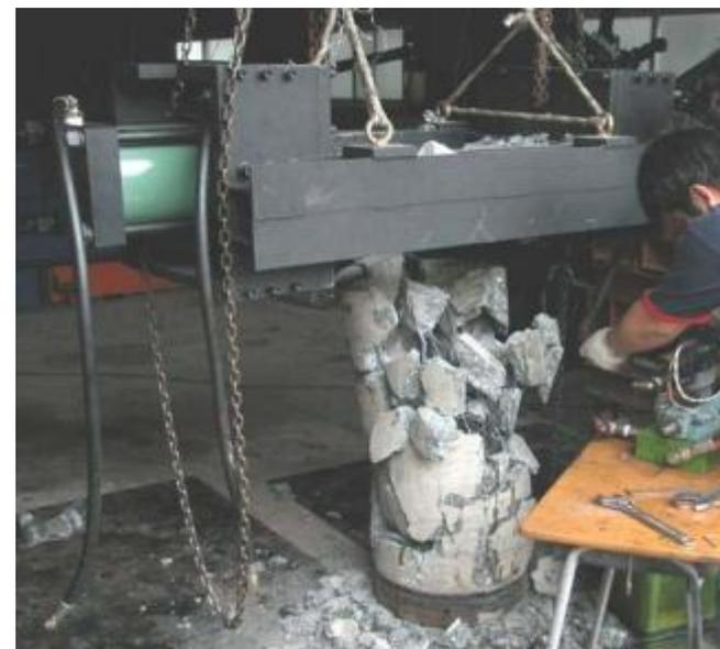
しかし、2方向からの切断では、縦方向に多数のクラックを発生した。
